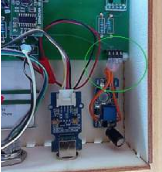
12. Collegare i pin del DC/DC converter alla PCB
