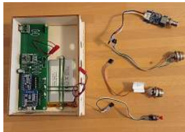
8. Collocare e avvitare la pcb nel vano
