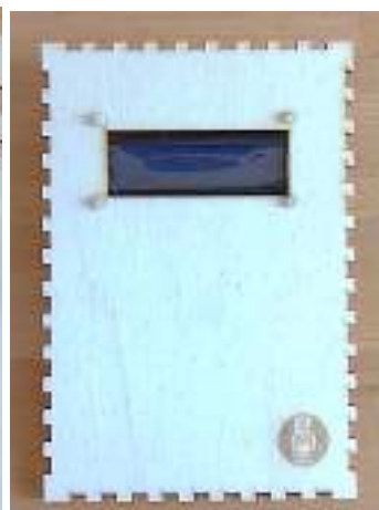
14. Posizionare il display sul retro e avvitare sulla parte frontale
