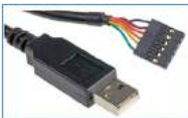
Il nodo TX è alimentato dalla batteria ricaricabile LiPo ricaricabile con il cavo USB-FTDI collegato al PC o ad un alimentatore plug-in da 5V. Il cavo FTDI va inserito nei sei pin maschi della scheda TTGO in modo che il filo nero (GND) stia a sinistra guardando la scheda con i 6 pin verso il basso.
